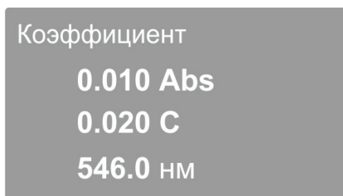
Рисунок 18 - Измерение с расчётом концентрации по коэффициентам.
