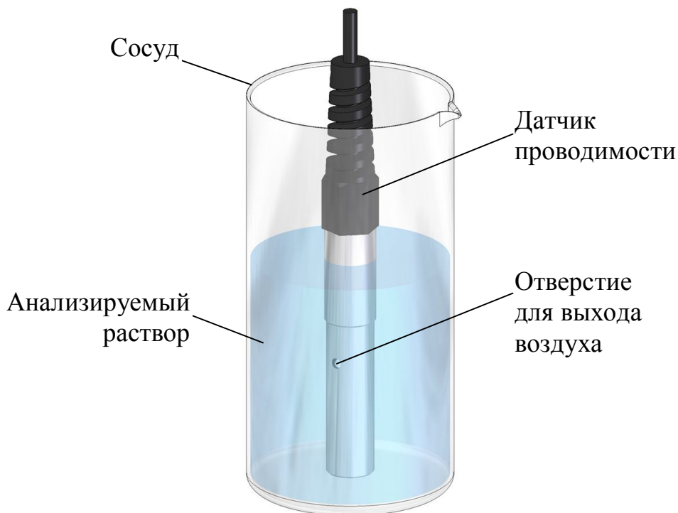
Рисунок 2.3 – Проведение измерений погружным методом
