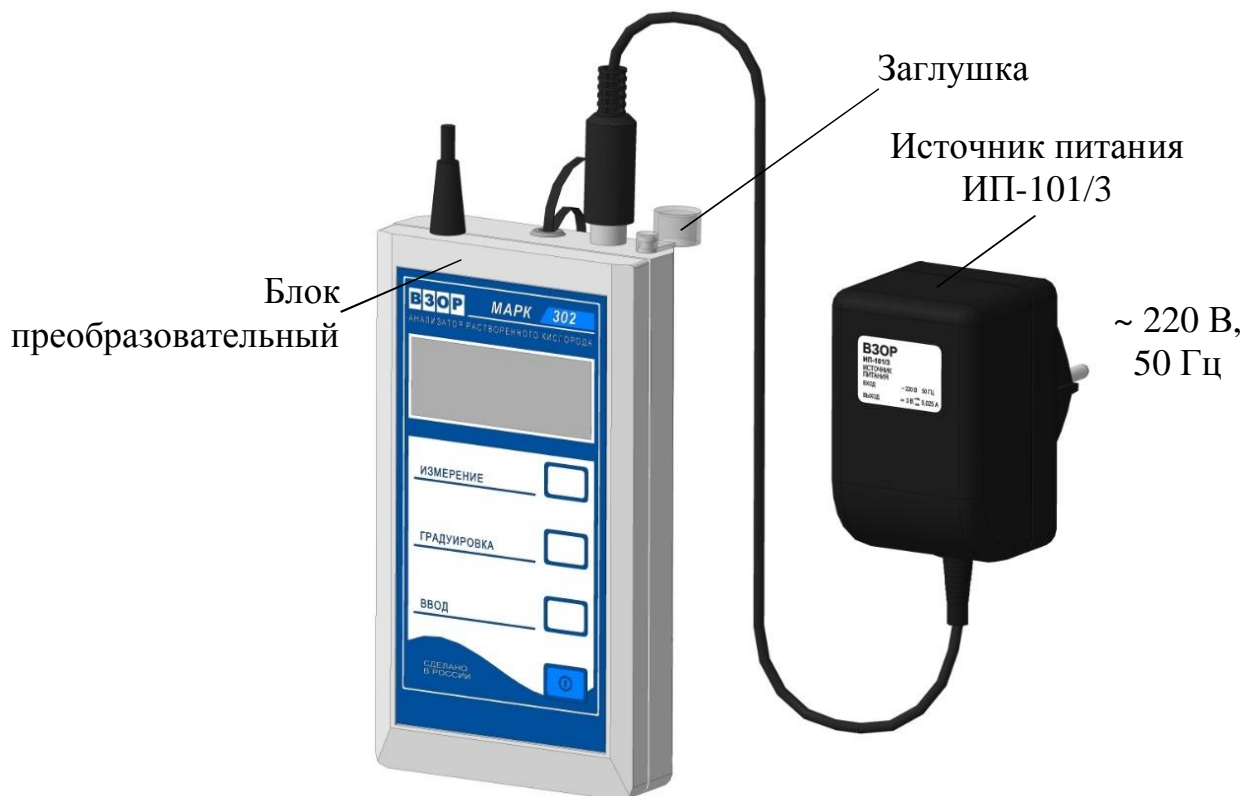
Рисунок 3.3 – Зарядка аккумуляторных батарей
