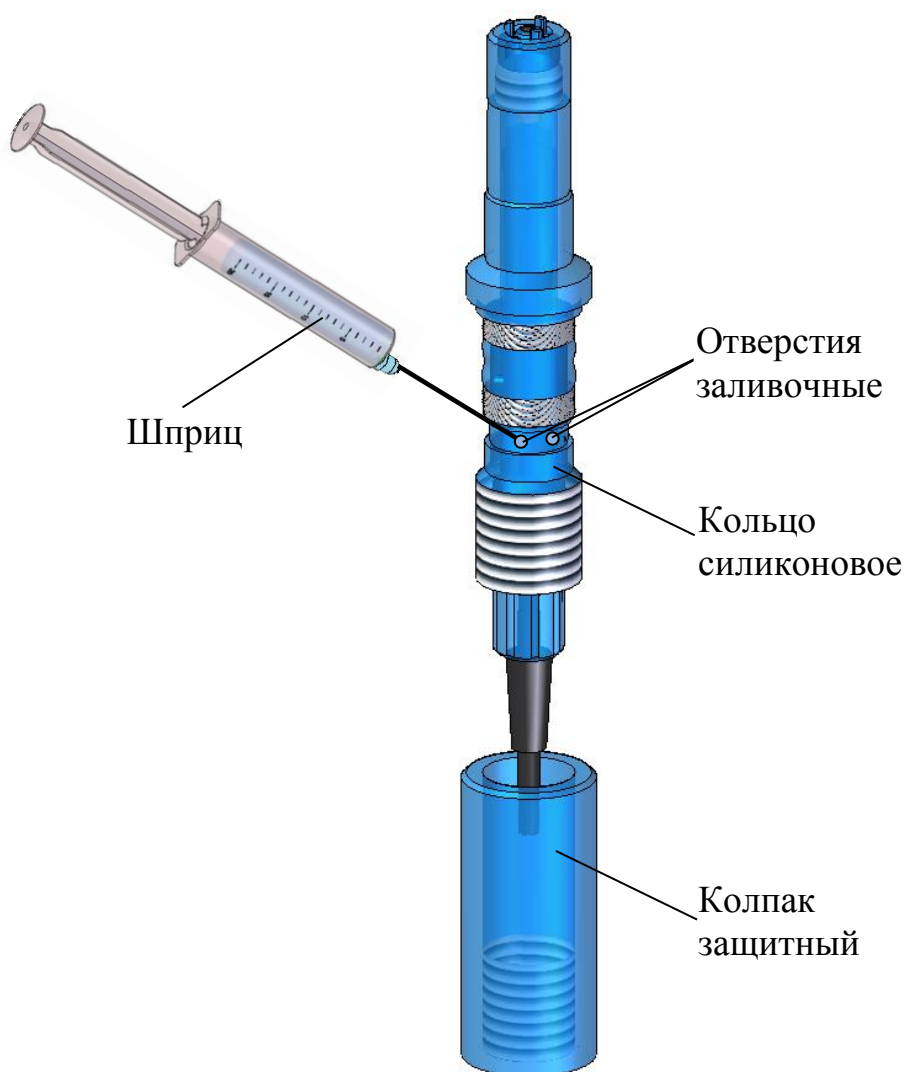
Рисунок 3.1 – Замена электролита ЭК
