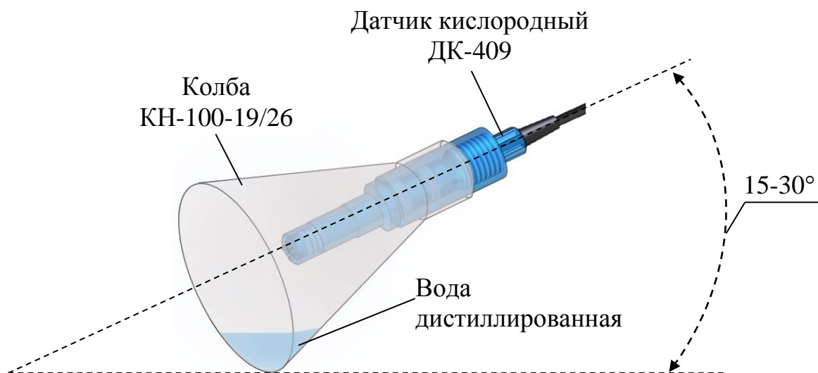
Рисунок 2.8 – Градуировка датчика ДК-409
