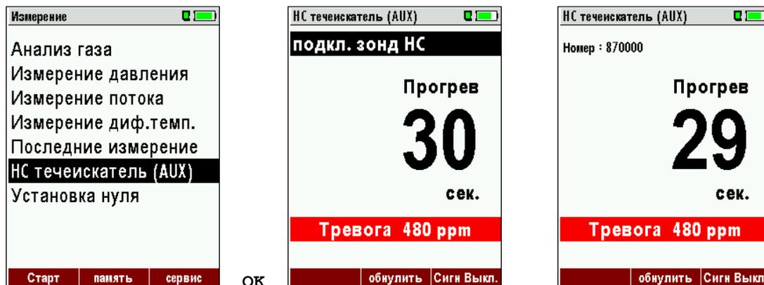
Пока выносной течеискатель не подключен к газоанализатору OPTIMA 7 на дисплее возникает мигающее сообщение „подкл. зонд НС“.
