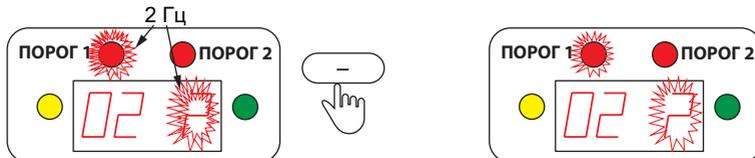
После включения/выключения режима  $O_2$  прибор возвращается в режим "Установка порога 1".
