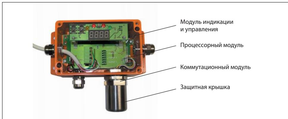
Рис.3. Основные узлы газоанализатора "Сенсон-СВ" моделей 5022 и 5023
