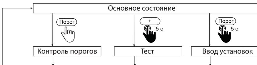
Основное состояние ГА (рабочий режим) – измерение, на индикаторе отображается концентрация. Газоанализатор возвращается в Основное состояние автоматически, если в течение 30 с не нажимали кнопки. Переход в любой из трех режимов управления происходит только из Основного состояния.
