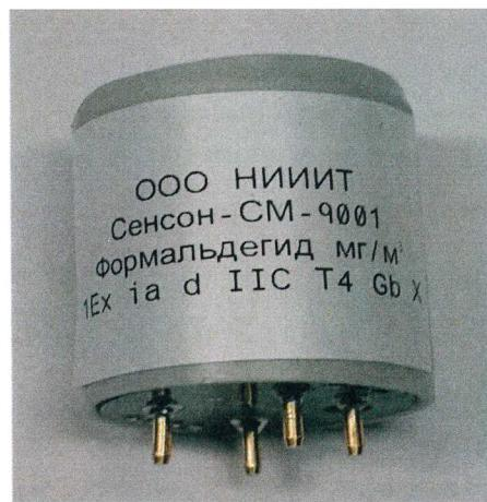
Рисунок 7 - Общий вид исполнения СМ (измерительный интеллектуальный модуль)
