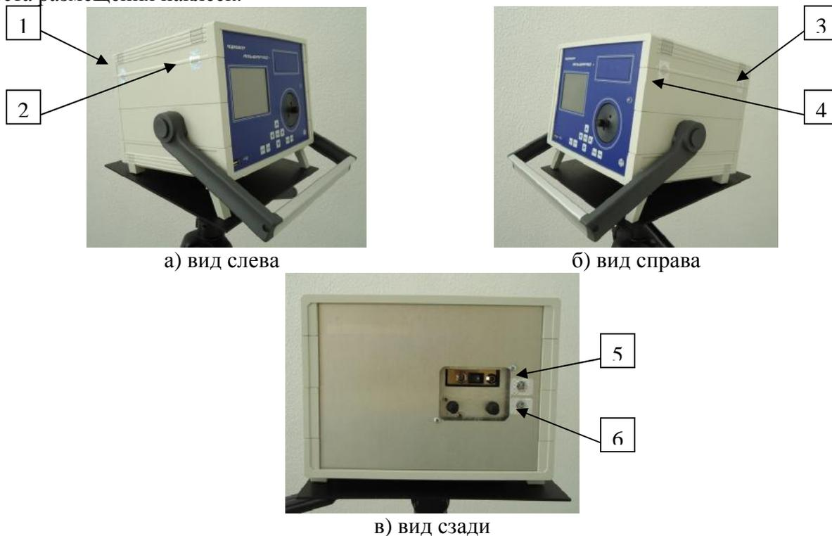
Рисунок 2 Схема размещения специальных пломб (1, 2, 3, 4, 5, 6 – места размещения пломб)
