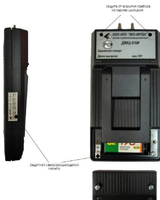
Рис. 2. Места наклеивания пломбы и перфорации на заднем шильдике для защиты от вскрытия.
