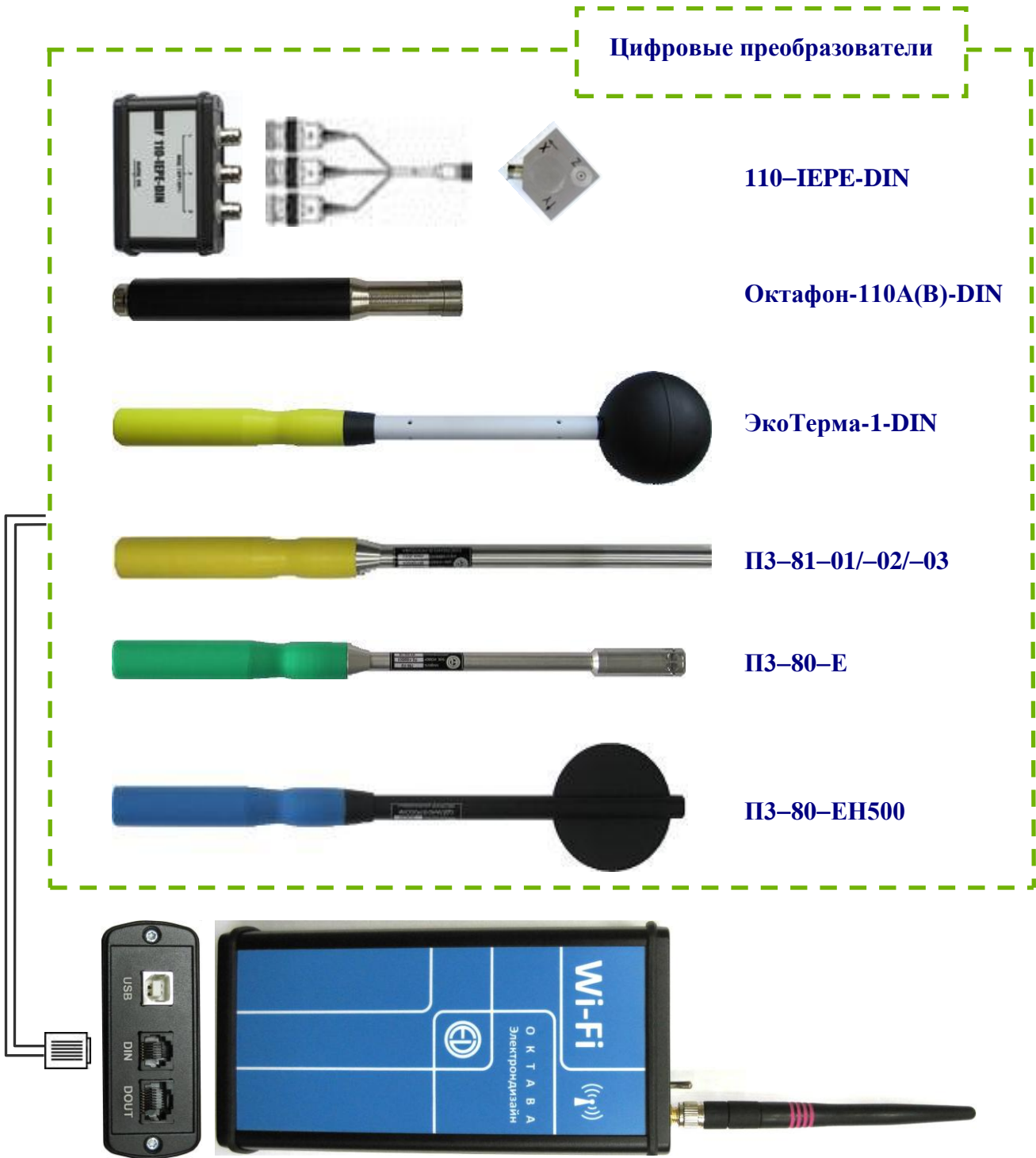
Схема 5.2. Подключение цифровых преобразователей к адаптеру ЭКО-DIN-DOUT (RF) через порт DIN
