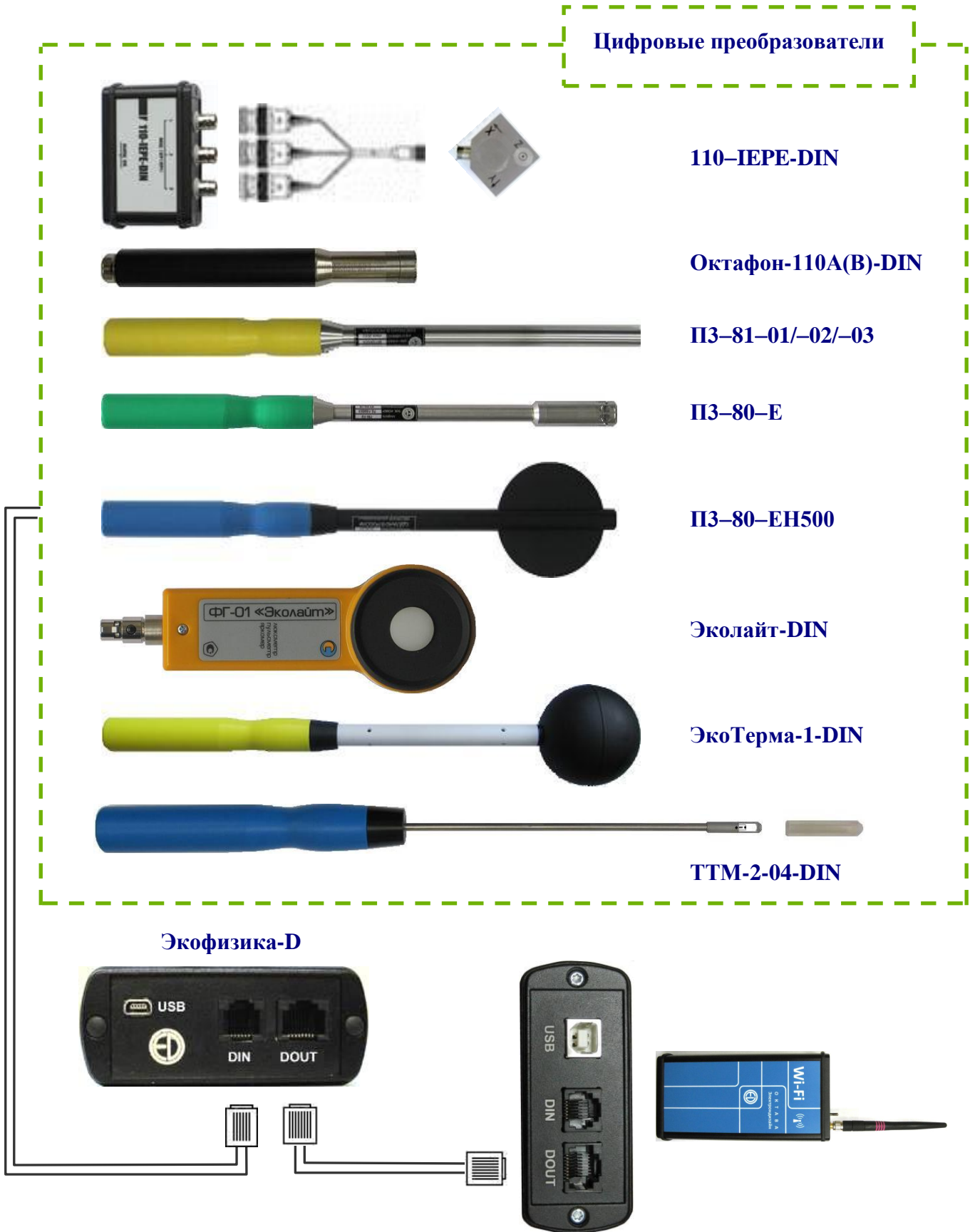
Схема 5.3. Подключение цифровых преобразователей через порт DOUT с использованием ИБ ЭКОФИЗИКА-D к адаптеру ЭКО-DIN-DOUT (RF)
