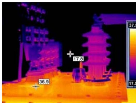
Рисунок 4. Точки измерений и цветовая шкала температуры
