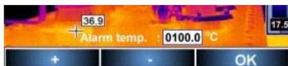
**Рисунок 23. Установка значения температуры срабатывания сигнализации**
