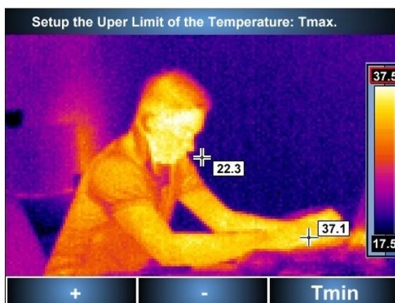
Используя клавиши **F/+** и **M/⊙**, установите необходимое значение верхней границы диапазона температур. Выбранное значение отображается на термограмме (дополнительно выделено красной рамкой). Нажмите клавишу **P/⊙** для выбора режима установки нижней границы диапазона температур. Установка значений  $T_{min}$  аналогична  $T_{max}$ .
