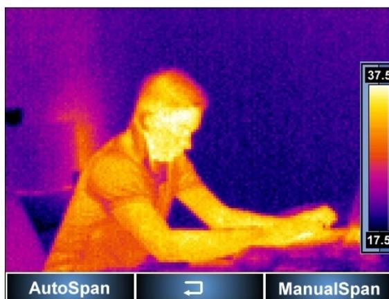
Нажмите клавишу **F/+** для выбора режима автоматической установки диапазона температур – максимальное и минимальное значение температуры будут автоматически выбираться, исходя из значений, которые попали в объектив тепловизора.
