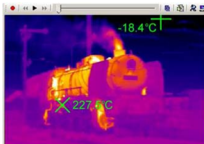
Рисунок 57. Метки точек со значениями максимальной и минимальной температур
