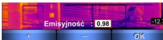
Рисунок 23. Подменю регулировки выбранного параметра
