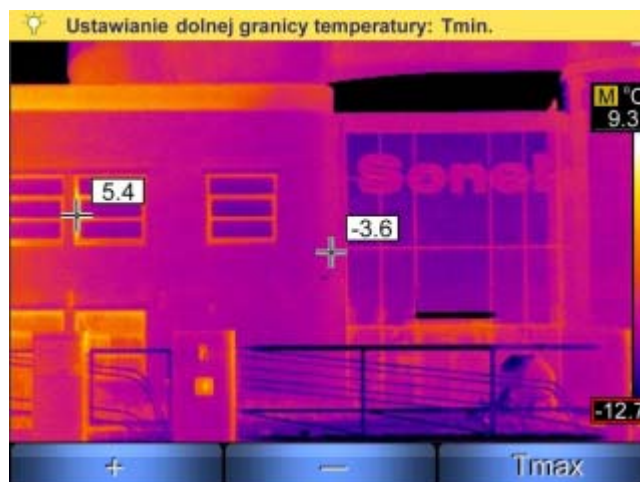
Рисунок 9. Установка нижней границы диапазона температур (значение в красной рамке)
