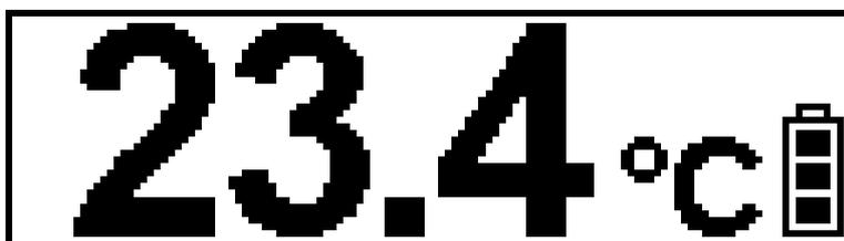
Рис. 3 – Вид дисплея прибора в режиме «Температура воздуха»
