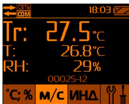
Рис.13 – Измерение радиационной температуры, температуры и влажности.
