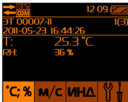
Рис.10 – Меню выхода в режим измерений из режима просмотра памяти БОИ-01
