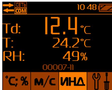
Рис.20 – Режим определения точки росы
