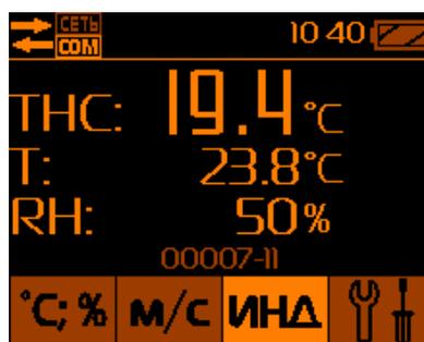
Рис.16 – Определение ТНС-индекса с подключённым датчиком «чёрный шар»
