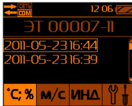
Рис.8 – Индикация сохраненных в памяти БОИ-01 2-х сессий, измеренных с помощью измерительной головки с заводским номером №00007-11
