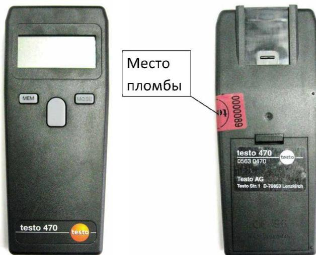
Рисунок 3. Фототахометр электронный Testo-470
