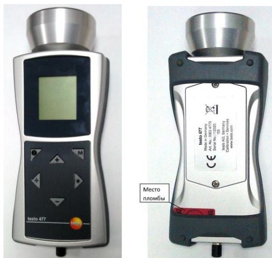
Рисунок 5. Строботактометр электронный Testo-477
