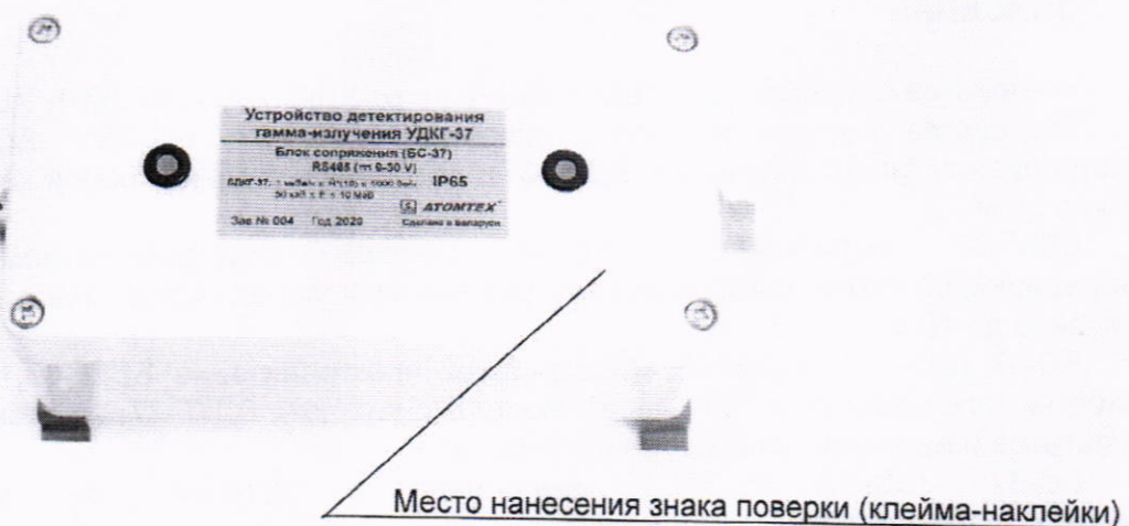
Рисунок 2 – Место нанесения знака поверки (клейма-наклейки)
