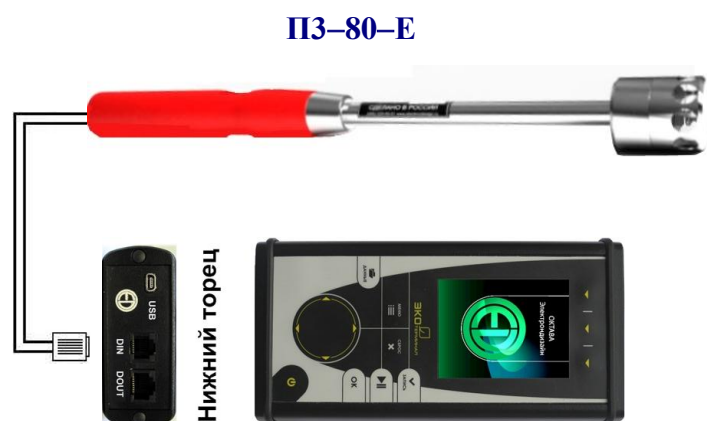
Рис.1. Подключение ПЗ-80-ЕН500 к ИБ ЭКОФИЗИКА-Д
