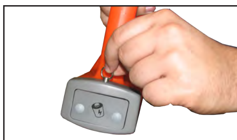
а) Выдвинуть фиксатор и освободить батарейный отсек
