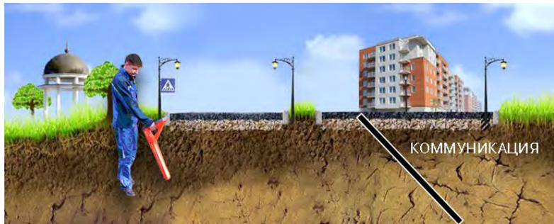
3. При движении в сторону предполагаемого места расположения коммуникации изображение на экране появится «шарик». Его наличие показывает присутствие коммуникации на значительном удалении от оператора.
