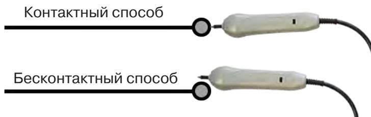
В режиме индикатора электрического поля датчик позволяет проводить отбор «своего» кабеля без создания в коммуникации переменного тока (рис. 10.6), поиск мест прохождения скрытой проводки и мест обрыва небронированного кабеля при наличии к нему непосредственного доступа.
