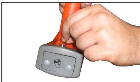
а) Выдвинуть фиксатор и освободить батарейный отсек
