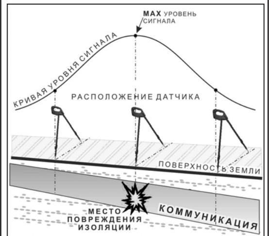
Если пройти тот же участок в обратном направлении (к генератору) не «развернув» приемник и предварительно произведя «сброс показаний» (кнопкой « $\nabla$ »), то показание «минус  $5^\circ$ » и более указывает на вероятность наличия дефекта.
