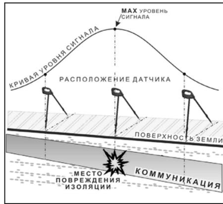
**4. Фазовый «двухчастотный» метод « $\Delta\phi$ »**
