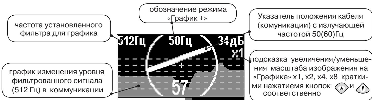
5. Подойти к предполагаемому месту прохождения коммуникации, на которую подан сигнал с генератора. Расположить ось приемника параллельно оси коммуникации.
