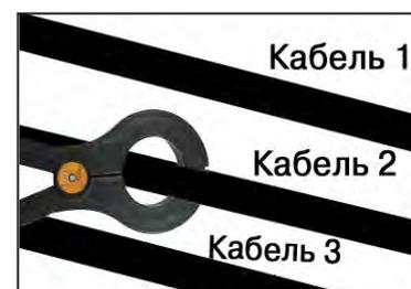
Поочередно измеряя уровни сигналов на кабелях в пучке, «выделенный» кабель определяется по наибольшему уровню сигнала (рис. 10.5).
