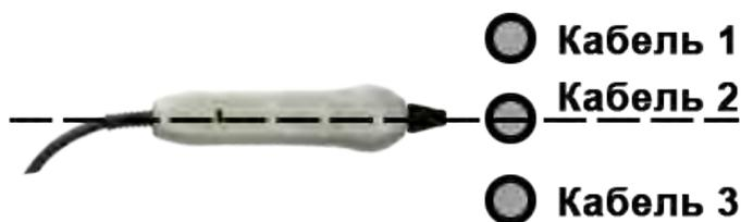
**Важно!** Чтобы не ошибиться с выбором «своего» кабеля, необходимо производить сравнение измеренных датчиком уровней сигналов в кабелях как по максимальному, так и по минимальному сигналу.
