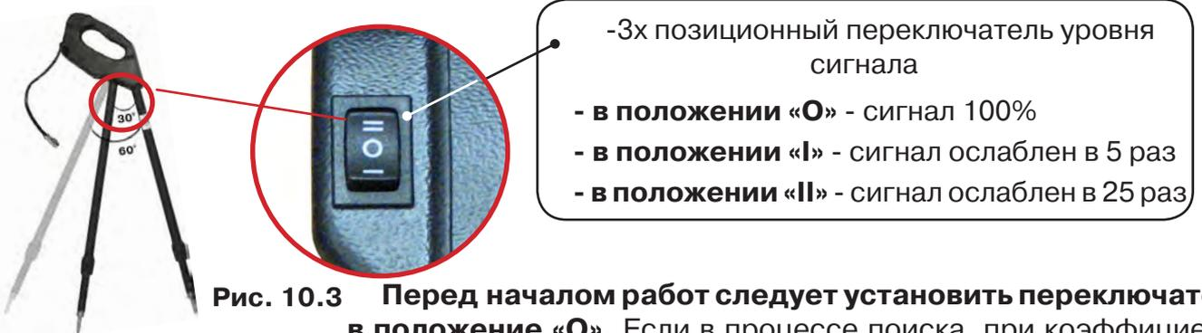
**Рис. 10.3** Перед началом работ следует установить переключатель в положение «O».
