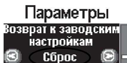
При заводских настройках можно проводить трассировку силовых кабелей с сетевой частотой 50 Гц, в пассивном режиме.
