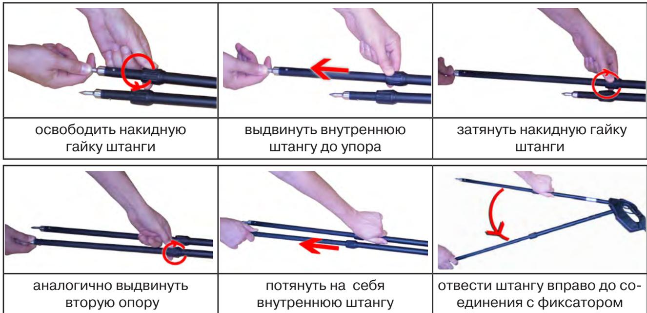
Среднее положение фиксатора соответствует углу  $30^\circ$ , крайнее - углу  $60^\circ$  (рис. 10.3). Максимальное расстояние между электродами соответствует максимальной чувствительности.
