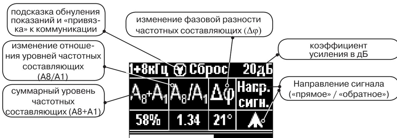
**ВАЖНО!!!** Наборы экранов разбиты на два: базовый и расширенный. В базовом наборе доступны два экрана: «трасса» и «график». В расширенном пять экранов: «трасса», «график», «график+», «MIN&MAX» и «2 частоты». Переключение наборов осуществляется в настройке меню «Параметры».
