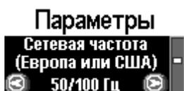
Европа/США (Сетевая частота для фильтров пассивного поиска: «Европа» (50 и 100 Гц) / «США» (60 и 120 Гц). )
