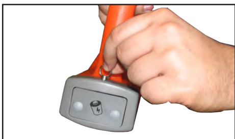
а) Выдвинуть фиксатор освободить батарейный отсек
