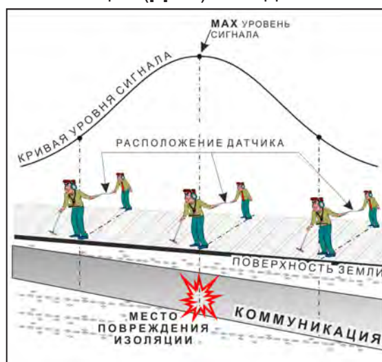
применение датчика-определителя дефектов коммуникации (ДОДК) методом тах
