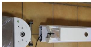
Весовая платформа закрепляется с помощью 4-х болтов
