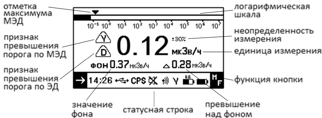
Рисунок 2.6 – Вид дисплея в режиме индикации мощности дозы (детальное представление)
