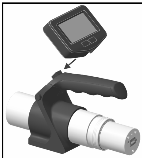
Рисунок 2.3 – Установка пульта на ручке держателя
