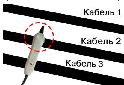
Выбор кабеля по максимальному сигналу
