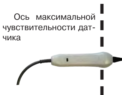
Выбор кабеля по максимальному сигналу
