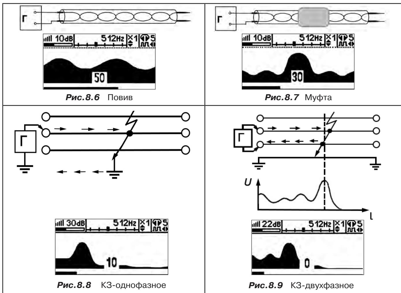
Генератор подключают к двум поврежденным жилам кабеля и производятся работы по отысканию места повреждения на трассе кабельной линии.
