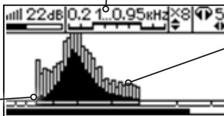
светлые сегменты соответствуют частотным составляющим случайных помех
