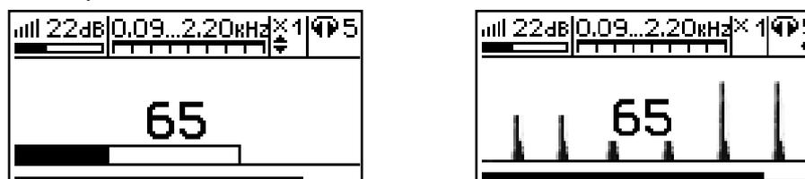
Режим «Утечка» рекомендуется использовать не только при поиске источника шума от утечки энергоносителя в трубопроводах, но и при трассировке трубопровода с использованием ударного механизма и при поиске места дефекта кабеля с применением генератора высоковольтных импульсов для предварительной локализации источника импульсного шума и настройки полосы пропускания частотного фильтра в окне индикации «Спектр».
