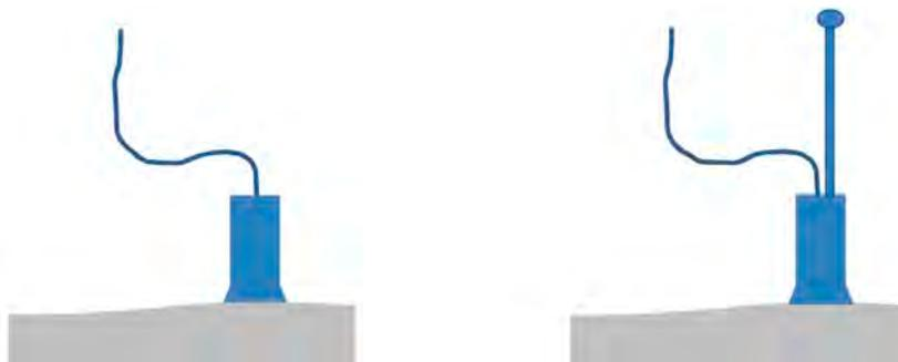
При работе исключите нажим на датчик, т.к. при этом чувствительный элемент может упираться в механический ограничитель вертикального перемещения, что приведет к появлению в головных телефонах посторонних звуков и искажению сигнала.
