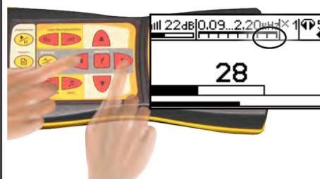
**Месту дефекта соответствует точка с максимальным уровнем «полезного» сигнала (рис. 6.2).**
