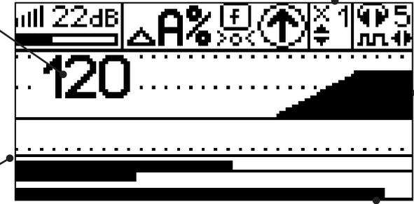
«**Нижняя**» шкала отображает уровень входного сигнала регулируемый кнопками «чувствительность»
