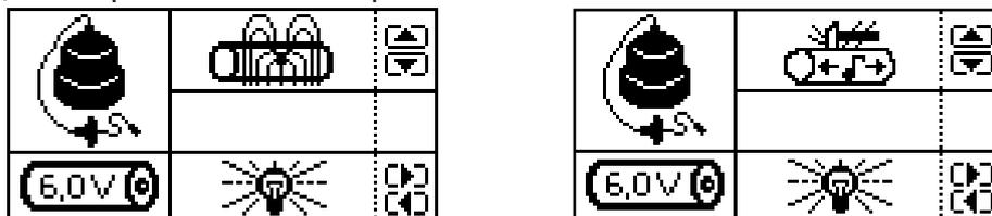
Режим «Утечка» - используется для поиска и анализа сигнала шумов, таких как звук утечки энергоносителя в трубопроводах.
