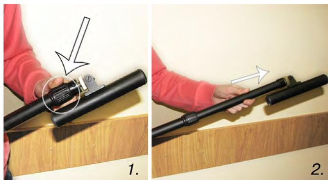
2.2 Ослабить фиксирующую гайку (1) и установить электромагнитную антенну (2) датчика в положение, используемое в трассопоиске. Зафиксировать положение фиксирующей гайкой. Горизонтальное положение – трассопоиск по методу максимума, транспортное положение – трассопоиск по методу минимума
