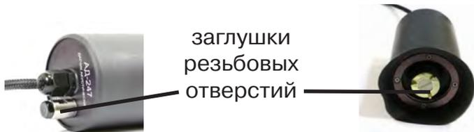
Акустический датчик АД-247 выполнен с резьбовыми отверстиями для установки съёмных наконечников (магнит поз.2, штыри поз.3 и поз.4) и составной ручки поз.5. В состав датчика входят также пластиковые винты-заглушки (для защиты резьбовых отверстий от попадания воды и грязи) и к ним
