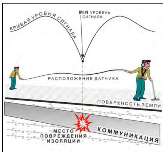
применение датчика-определителя дефектов коммуникации (ДОДК) методом min
