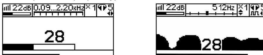
Режим «Удар» - используется при поиске и анализе импульсных сигналов, таких как звуки от ударного механизма и звуки искровых разрядов, которые образуются в месте дефекта кабеля при подаче высоковольтных импульсов.
