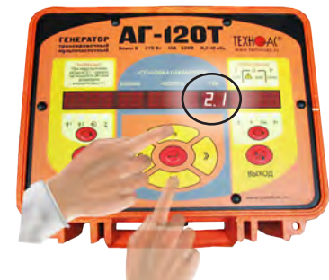
8. Установить трассировочный «ток» в коммуникации
