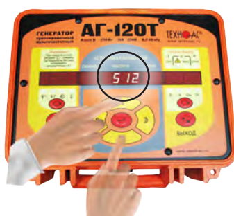
6. Установить частоту генерации (512/1024/8192 Гц)
