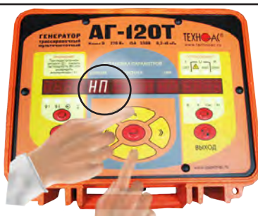
4. Установить вид сигнала (непрерывный «НП» / прерывистый «ПР» / двухчастотный «2F»)
