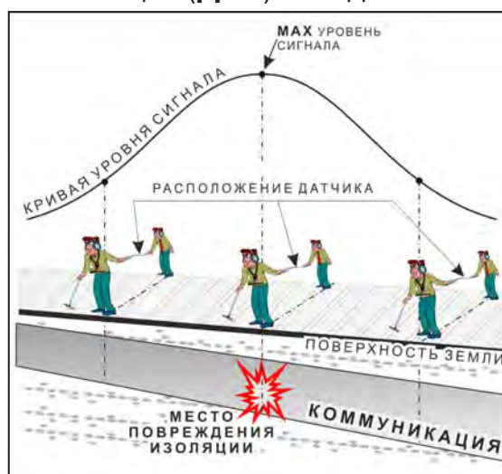
применение датчика-определителя дефектов коммуникации (ДОДК) методом max
