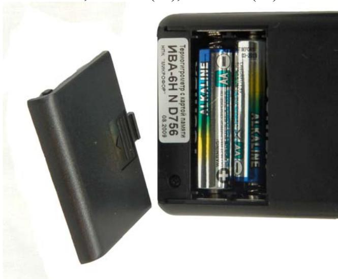
Рисунок 1. Место пломбирования защитной наклейкой для термогигрометров ИВА-6А, ИВА-6АР, ИВА-6Н, ИВА-6НШ
