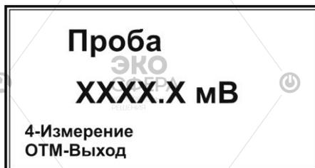
Нажмите кнопку **ИЗМ 4**. Начнется измерение ЭДС и отсчет времени измерения:
