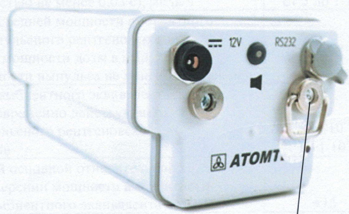
Рисунок 2 – Место пломбирования для защиты от несанкционированного доступа
