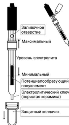
**4.3** Залить\* в электрод через отверстие, расположенное в его верхней части, раствор KCl концентрацией 3,0М, 3,5М или насыщенный при 20°C (4,2 М). Если заправка электрода производится впервые, то измерения следует проводить не ранее чем через 8 ч. В дальнейшем в электрод следует доливать раствор KCl той же концентрации.
