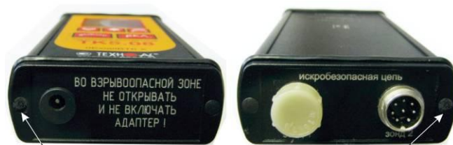
Пломбировка углублений с крепежными винтами пластикой FIMO с последующим оттиранием клея
