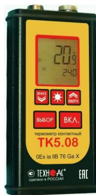
Рисунок 11 – Общий вид термометров контактных цифровых ТК-5 модификации ТК-5.08
