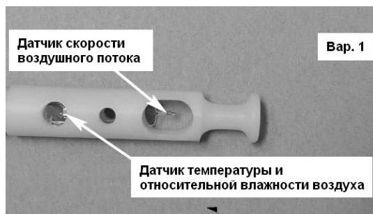
Рисунок 4. Расположение датчика скорости воздушного потока и датчика температуры и относительной влажности воздуха в сенсометрическом щупе измерителя Метеоскоп-М.
