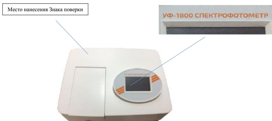
Рисунок 3 - Внешний вид спектрофотометров моделей УФ-1800
