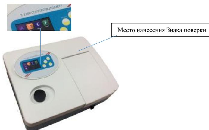
Рисунок 1 - Внешний вид спектрофотометров моделей В-1100, УФ-1100
