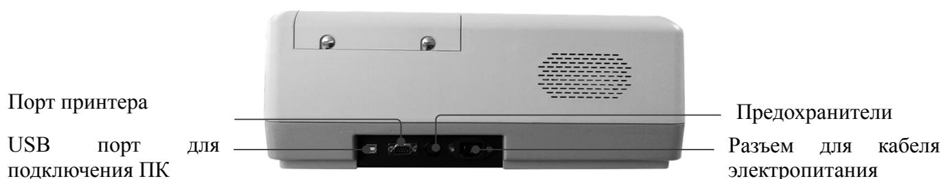
Таблица – Устройство прибора
