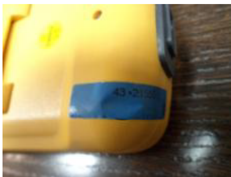
Рисунок 2. Фотография пломбирования мультиметров цифровых серии VA1
