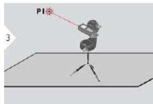
Определите измеряемую точку на расстоянии более 8 м. Наведите на определенную точку и нажмите кнопку DIST для запуска пятисекундного отсчета до выполнения измерения.
