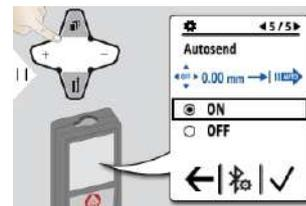
Выберите автоматическую или ручную передачу значения.
