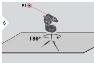
Поверните прибор на 180°. Снова наведите на определенную точку и нажмите кнопку DIST для запуска пятисекундного отсчета до выполнения измерения.
