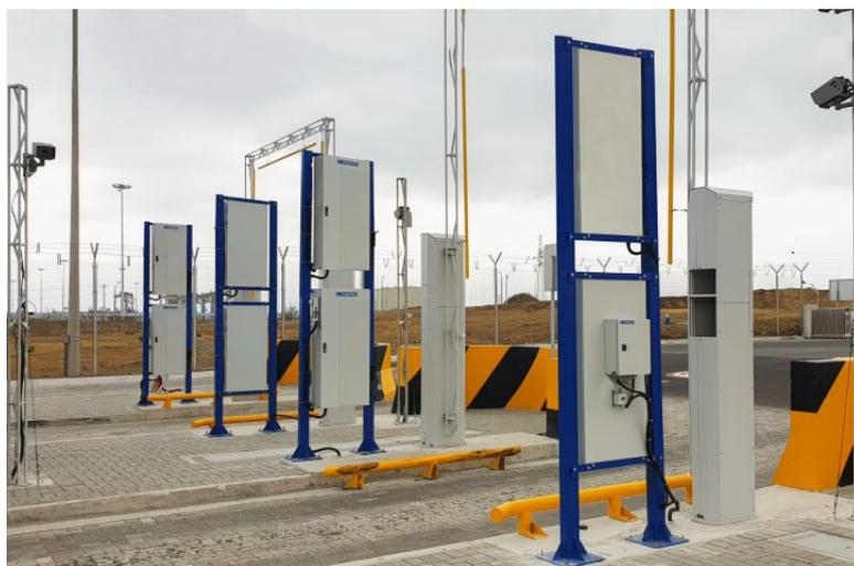
Автоматическое стационарное средство непрерывного радиационного контроля, предназначенное для обнаружения источников гамма- и нейтронного излучения в транспортных средствах, пересекающих контрольно-пропускные пункты.
