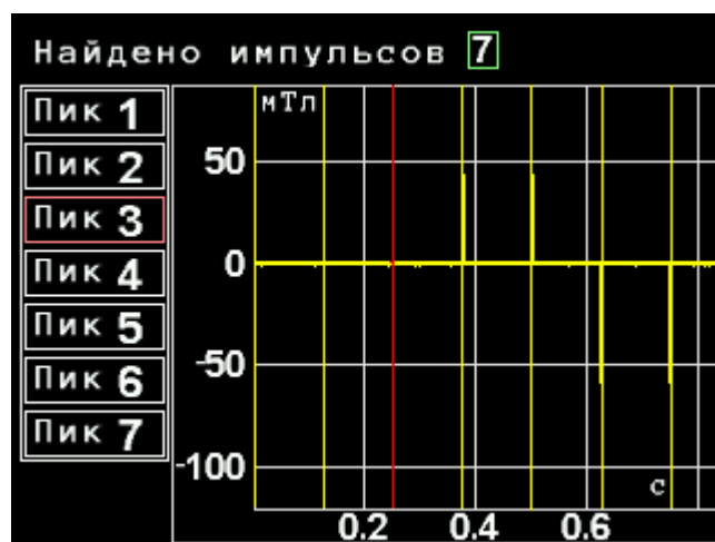
Рисунок 3.25 Графическое отображение вида измеренного сигнала с выделением выбранного импульса магнитного поля. Режим «Тесламетр»
