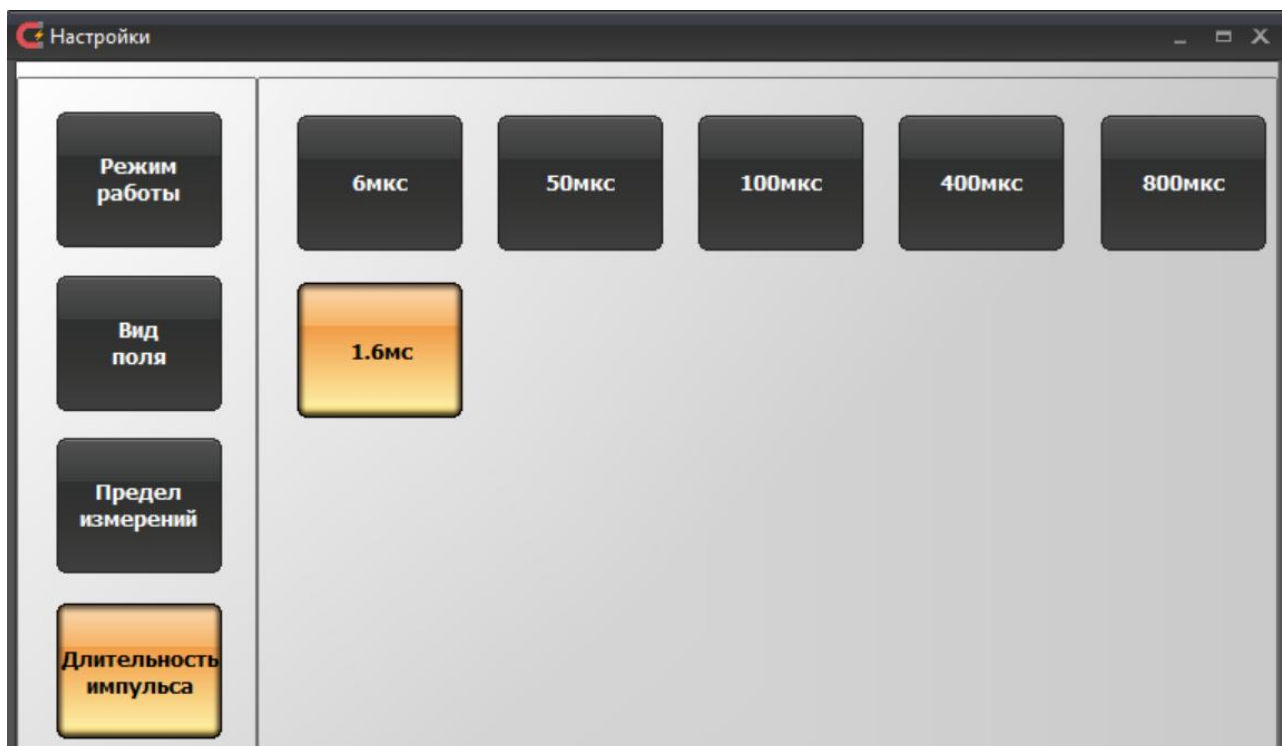
Рисунок 18. Окно настроек программы управления ТПУ-2В в режиме «Тесламетр». Группа параметров «Длительность импульса», измерение импульсного магнитного поля.
