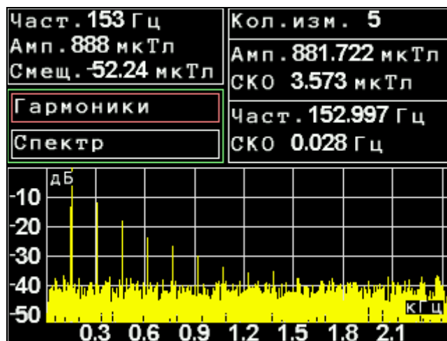
Рисунок 3.17. Результаты измерения параметров переменного магнитного поля. Режим «Тесламетр»
