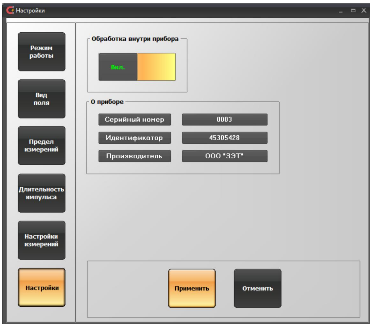
Рисунок 20. Окно настроек программы управления ТПУ-2В в режиме «Тесламетр», измерение импульсного поля. Группа параметров «Настройки»
