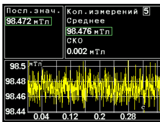
Рисунок 3.14. Результаты измерения параметров постоянного магнитного поля. Режим «Тесламетр»
