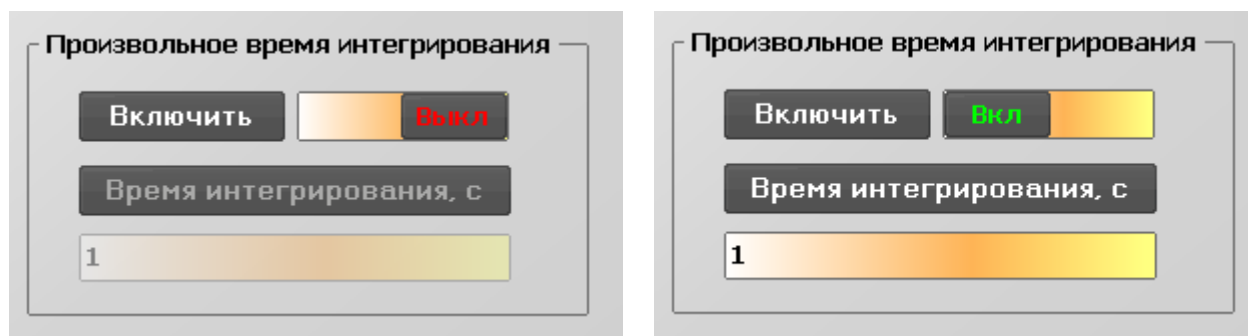
Рисунок 9. Окно настроек программы управления ТПУ-2В в режиме «Веберметр». Группа параметров «Время интегрирования». Область «Произвольное время интегрирования». Выключено (слева), включено (справа)
