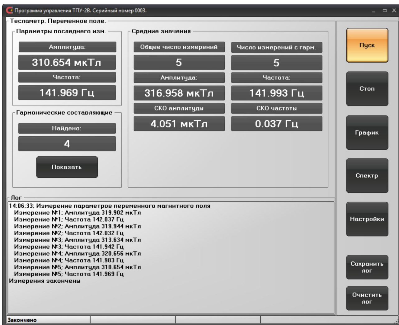
Рисунок 3. Главное окно программы управления ТПУ-2В в режиме «Тесламетр» (при измерении параметров переменного магнитного поля)
