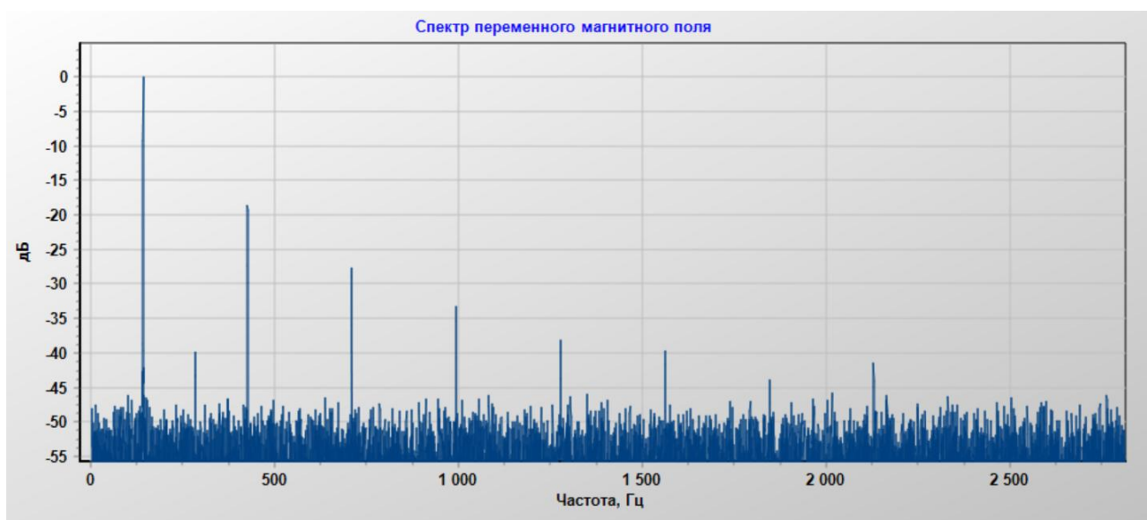
Рисунок 28. Режим «Тесламетр». Спектр переменного магнитного поля
