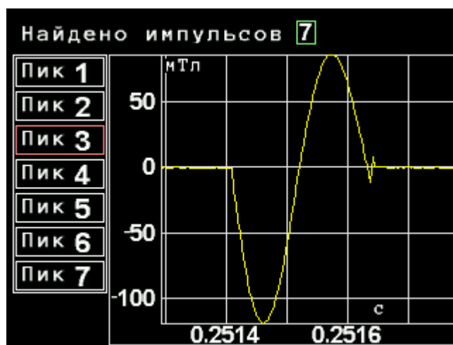
Рисунок 3.24. Графическое отображение вида выбранного импульса в режиме измерения параметров импульсного магнитного поля. Режим «Тесламетр»
