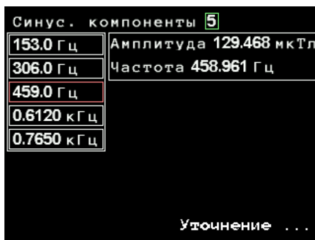
Рисунок 3.19. Процесс уточнения параметров сигнала в режиме отображения результатов «Гармоники» при измерении переменного магнитного поля. Режим «Тесламетр»
