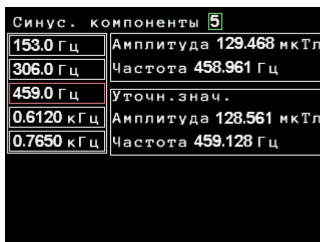
Рисунок 3.20. Результат уточнения параметров магнитной индукции в режиме отображения результатов «Гармоники» при измерении переменного магнитного поля. Режим «Тесламетр»
