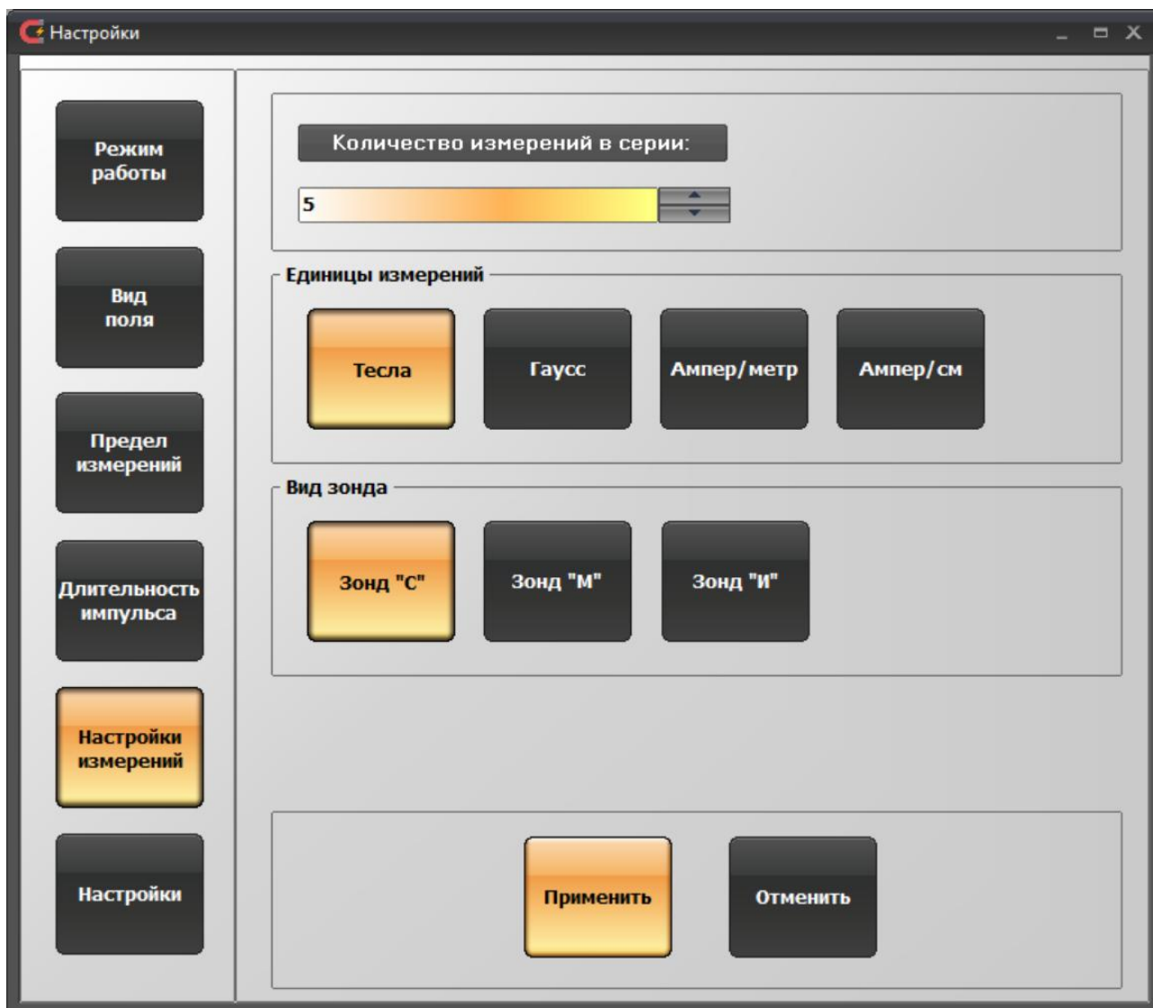
Рисунок 19. Окно настроек программы управления ТПУ-2В в режиме «Тесламетр», измерение импульсного поля. Группа параметров «Настройки измерений»
