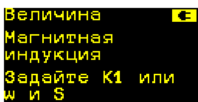
Рисунок 3.5 Дисплей веберметра при установке измерения магнитной индукции
