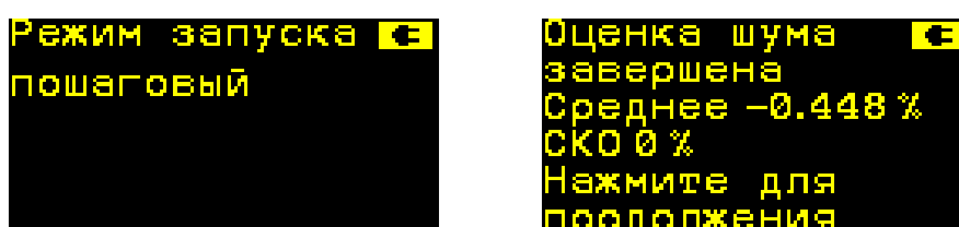
Рисунок 3.16. Дисплей веберметра в режиме измерения «Пошаговый»
