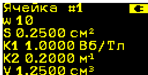
Рисунок 3.17. Дисплей веберметра после нажатия на клавишу выбора ячейки памяти
