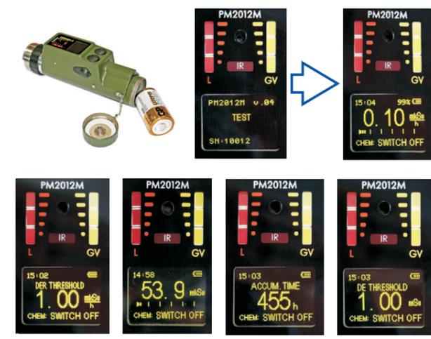
Гамма-канал прибора автоматически включается при установке элемента питания. Для включения гамма-канала прибора с установленным элементом питания необходимо нажать любую кнопку. После включения прибор переходит в режим тестирования, о чём свидетельствует соответствующая надпись на дисплее TEST, и, в случае успешного тестирования, далее в режим измерения МЭД гамма- и рентгеновского излучения.
