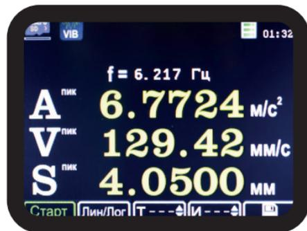
Рисунок 8. Режим «Виброметр».
