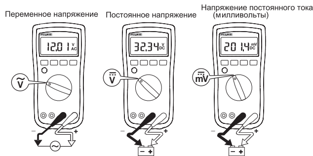
Рисунок 1. Измерение переменного и постоянного напряжения
