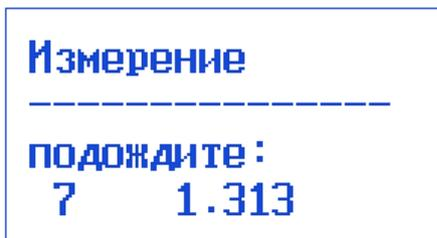
В нижней строке будут отображаться показания таймера: (обратный отсчет времени до завершения процедуры в секундах) и значение оптической плотности<sup>34</sup>.
