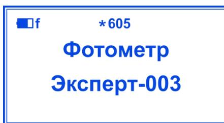
Если при использовании фотометрической ячейки типа ФЯ-1 картридж не подключен, на дисплее не будет отображаться значение рабочей длины волны. Подключите требуемый картридж.
