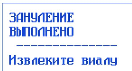
Извлеките виалу с дистиллированной водой. Анализатор перейдет в состояние ожидания установки виалы с пробой. На дисплее отобразится сообщение:
