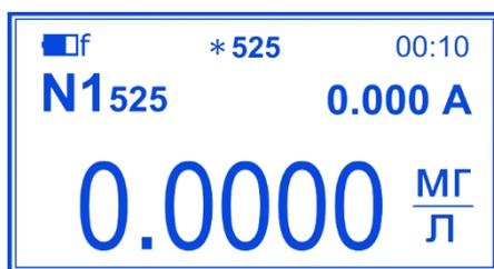
После измерения холостой пробы и обнуления показания оптической плотности извлеките кювету с холостой пробой и установите кювету с анализируемой пробой.
