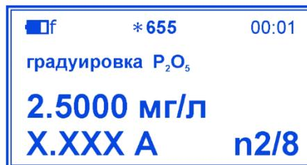
Вместо значков «X.XXX» будет отображено измеряемое значение оптической плотности раствора. После установления показания (примерно через 5-10 сек) нажмите кнопку «ВВОД». Подтвердите запрос о вводе изменений повторным нажатием кнопки «ВВОД». На дисплее будут отображены результаты градуировки по 2-ой точке<sup>37</sup>:
