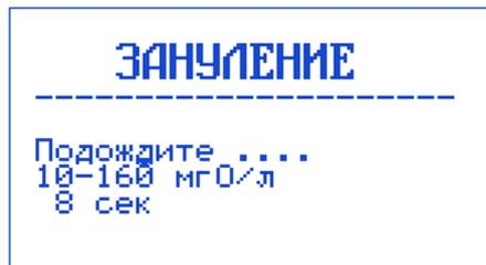
В нижней строке будут отображаться показания таймера: обратный отсчет времени до завершения процедуры в секундах.<sup>27</sup>
