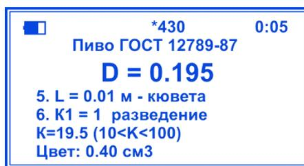
D – измеряемое значение оптической плотности;
