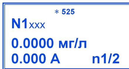
В верхней строке указана рабочая длина волны, во второй строке – № градуировочного графика, в двух нижних строках – координаты градуировочной точки (значения концентрации и оптической плотности, выраженной в единицах «А» или «Б» в зависимости от версии программного обеспечения фотометра). В правом нижнем углу указан номер текущей градуировочной точки и общее число точек градуировки, разделенные дробной чертой.<sup>15</sup>
