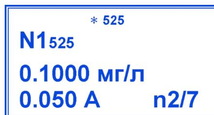
После измерения извлеките кювету, промойте дистиллированной водой, и внесите в нее третий градуировочный раствор, предварительно ополоснув им кювету.
