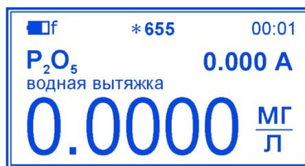
Извлеките кювету из кюветного отделения, вылейте раствор, ополосните дистиллированной водой и осушите фильтровальной бумагой. Перенесите в кювету фильтрат водной вытяжки из пробы грунта, обработанный реактивом Б. Установите кювету в кюветное отделение фотоячейки. Результат измерения массовой концентрации P<sub>2</sub>O<sub>5</sub> в анализируемом растворе (фильтрате водной вытяжки) отобразится в нижней строке крупным шрифтом, к примеру:
