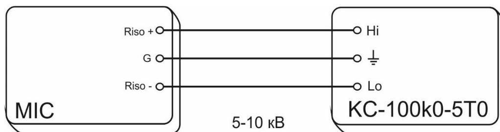
Рисунок 2 - Структурная схема определения абсолютной погрешности измерения сопротивления электроизоляции при номиналах сопротивлений до 5 ТОм с испытательным напряжением до 5 кВ.
