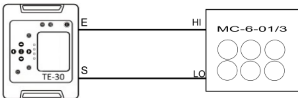
Рисунок 2 - Структурная схема проверки допускаемой абсолютной погрешности измерения электрического сопротивления защитных проводников
