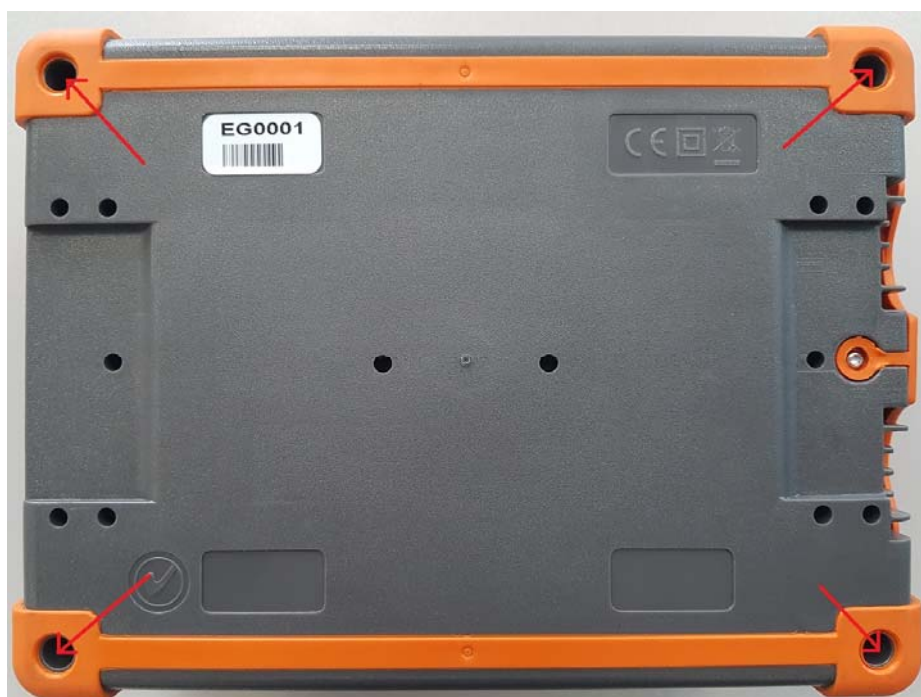
Рисунок 2 - Места пломбирования измерителей
