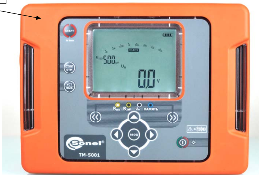
Рисунок 1 - Внешний вид измерителей и место нанесения знака поверки
