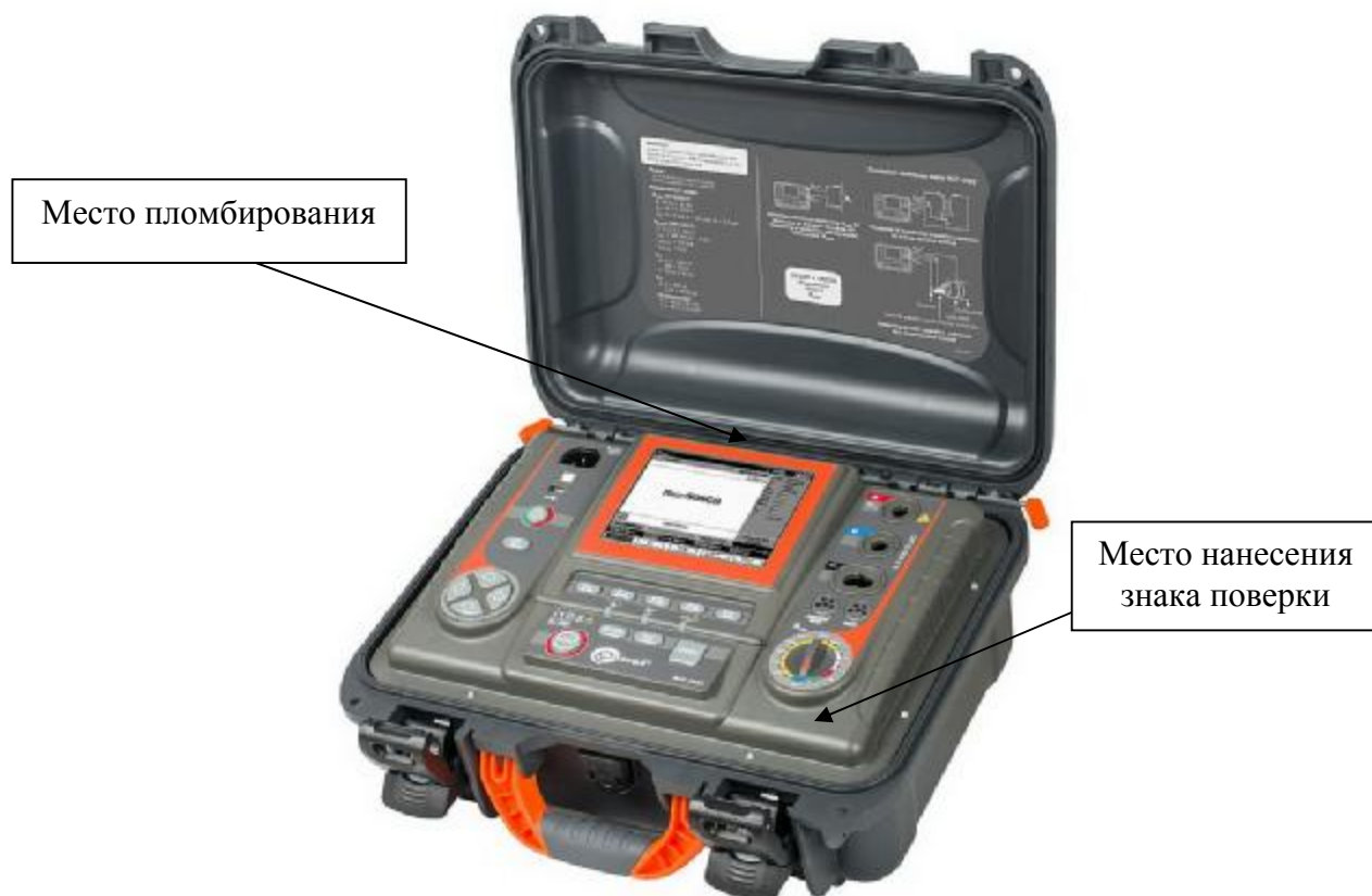
Рисунок 3 – Общий вид измерителей модификации МІС-5050, место нанесения знака поверки и места пломбирования
