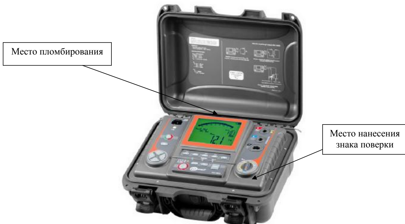
Рисунок 1 – Общий вид измерителей модификации MIC-5005, место нанесения знака поверки и места пломбирования
