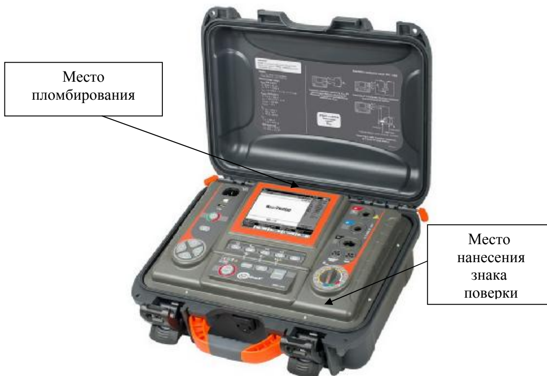
Рисунок 4 – Общий вид измерителей модификации МІС-10к1, место нанесения знака поверки и места пломбирования
