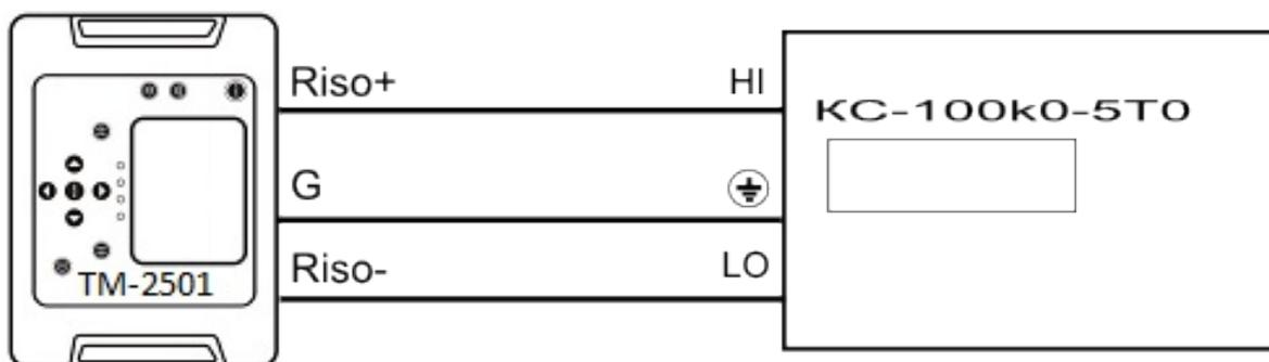
Рисунок 2 - Структурная схема определения абсолютной погрешности измерения сопротивления электроизоляции постоянным испытательным напряжением.
