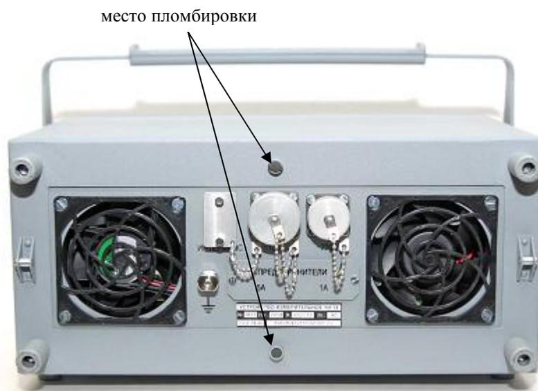
Рисунок 3 – Схема пломбировки устройства измерительного УИ-14.
