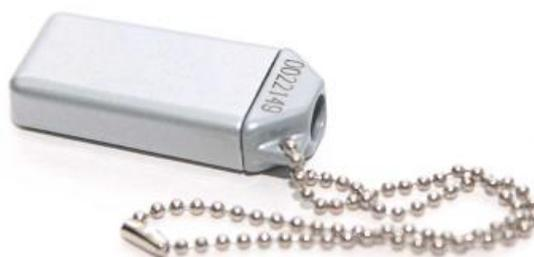
Рисунок 1 - Внешний вид измерителя поглощенной дозы ИД-14.
